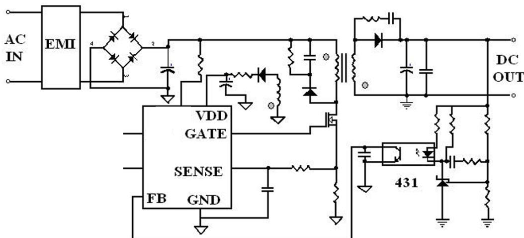
注 1：驱动脚 GATE 内置分段软驱动电路，直接连功率管栅极，一般不需要电阻/反向二极管 (GATE 脚驱动 source 电流，在米勒平台处约 20mA，过了米勒平台，会增大到 70mA)
